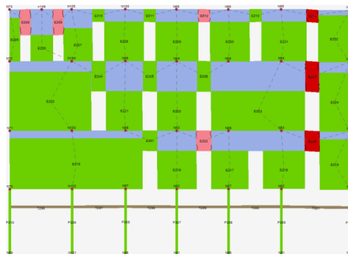
Figura 9.54: Stato di danneggiamento nella parete 10 disposta in direzione X all'ultimo step di carico.
