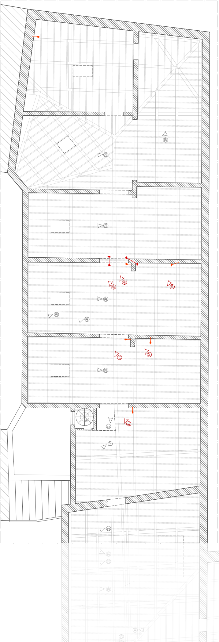
1D Presenza di fori di passaggio impiantistico nella muratura al di sopra dell'attacco non opportunamente risolti
