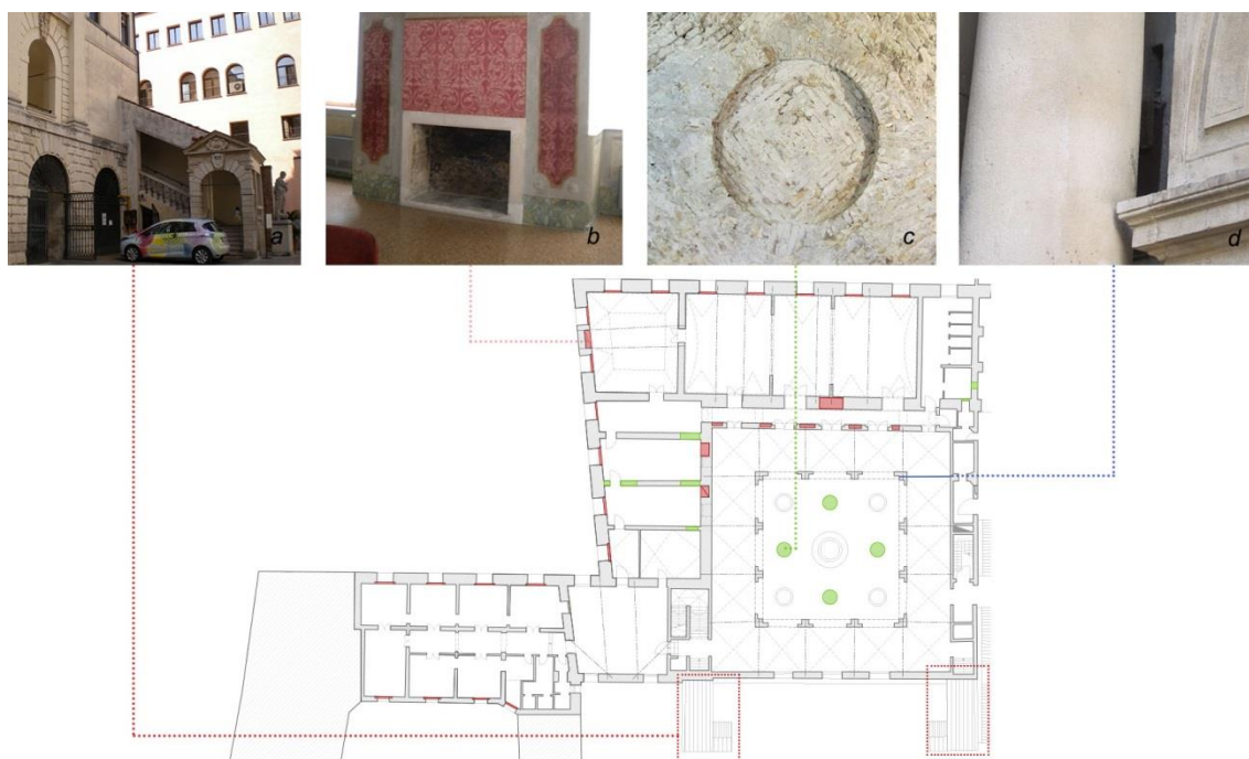
Figura 7.51: vulnerabilità in pianta, piano primo; a) irregolarità planivolumetriche; b) restringimenti della sezione muraria; c) aperture tamponate; d) catene vulnerabili.
