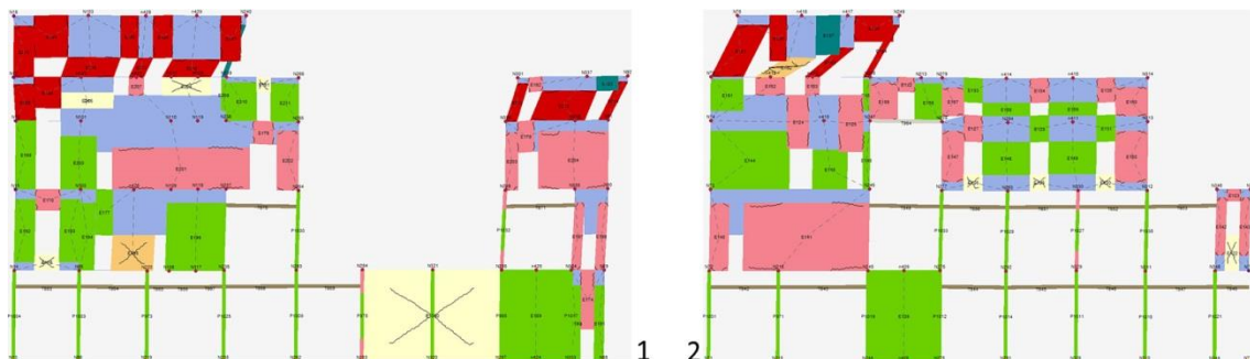
Figura 9.40: danneggiamento delle pareti 9 (1) e 7 (2) all'ultimo step di carico.
