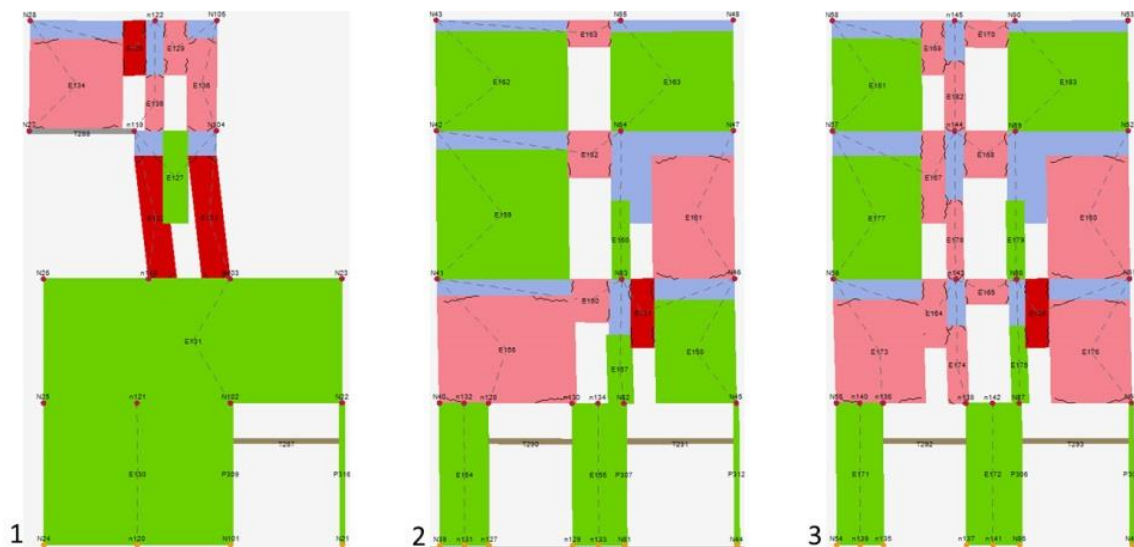
Figura 9.62: Stato di danneggiamento nella parete 5 (1), 7 (2) e 8 (3) all'ultimo step di carico.
