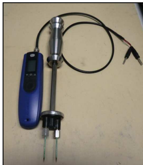
Figura 2.7. L'igrometro elettrico impiegato in laboratorio (GANN Hydromette blu H 40).
