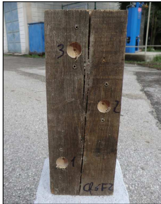
Figura 2.2. Campione tipo di castagno umido ricavato dalla trave posta fuori nel deposito. In questo campione sono già state rilevate le deformazioni (fori).
