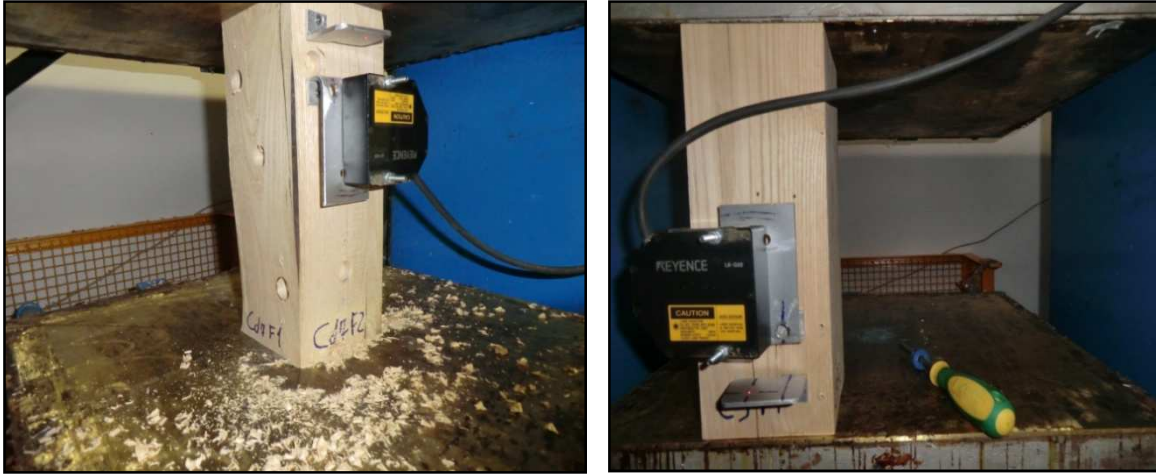
Figura 2.10. Campioni con distanziometro Keyence, posizionati al centro delle piastre della pressa. Nella foto a destra si può notare il laser riflettere nel bersaglio metallico.
