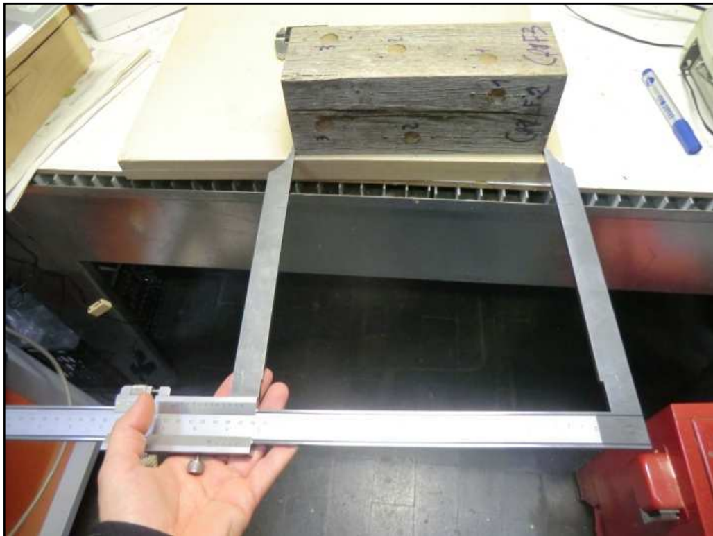
Figura 2.8. Misurazione dell'altezza di uno spigolo di un provino attraverso il calibro meccanico.
