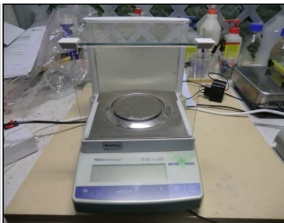
Figura 2.15. Bilancia con risoluzione di 1/1000 g impiegata per pesare i campioni.
