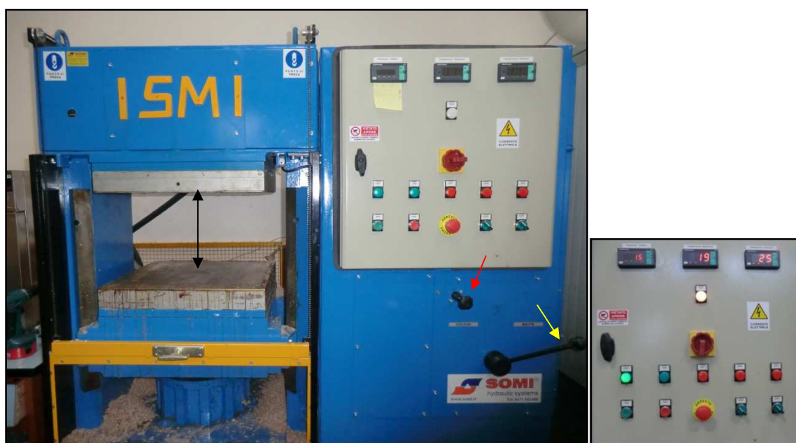
Figura 2.6. Pressa SIMI impiegata nelle prove di laboratorio: la freccia rossa indica la valvola idraulica; la freccia gialla il comando di carico e scarico; la doppia freccia nera mostra l'apertura della pressa (max 30 cm). A destra troviamo il pannello di controllo della macchina: il display in alto a sinistra fornisce la pressione in bar dell'olio del pistone, quello centrale la temperatura del piano superiore e quello a destra la temperatura del piano inferiore.
