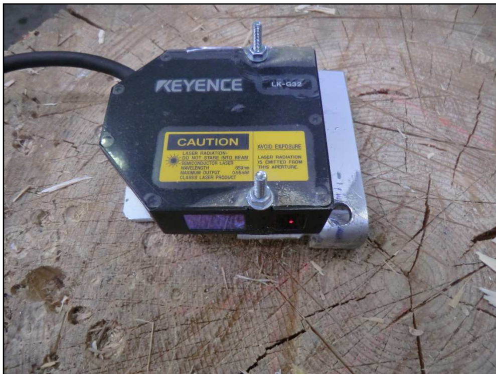
Figura 2.5. Comparatore al laser impiegato per le prove di laboratorio (KEYENCE LK-G32).
