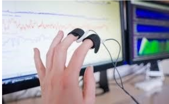
Figura 23 Misurazione della conduttanza cutanea. Presa da https://saravaleri.it/biofeedback-e-tecniche-di-rilassamento/
