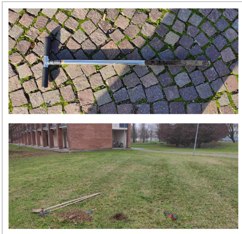
Figura 9: dall'alto: sonda pedologica manuale e scavo di minipit per l'analisi del suolo.
