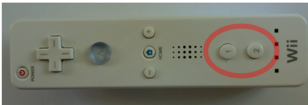
Figura 4.2: Pulsanti “1” e “2” per abilitare la modalità discovery
