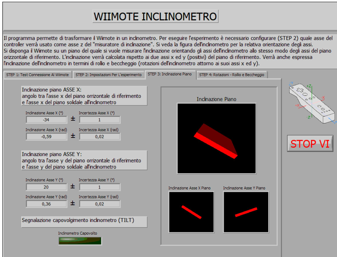
Figura 5.35: Interfaccia grafica STEP 3: Inclinazione Piano
