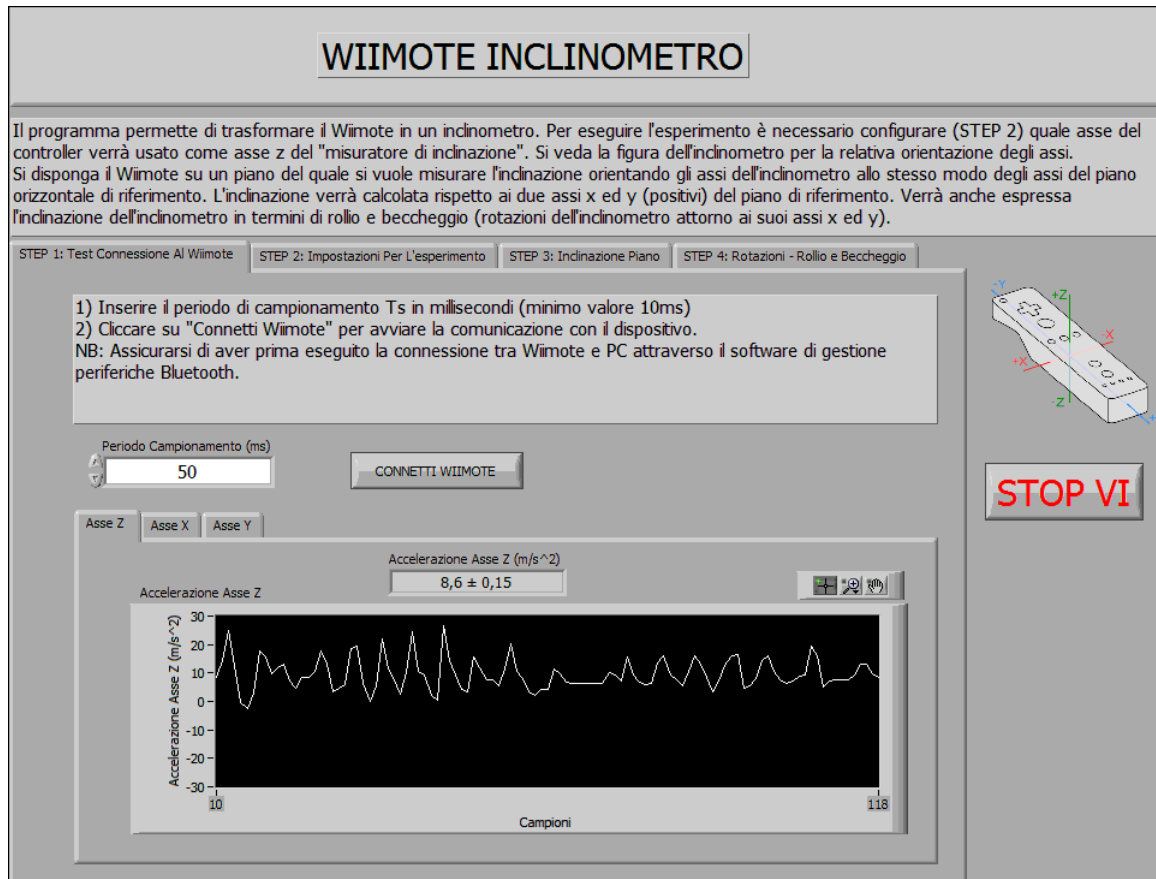
Figura 5.33: Interfaccia grafica STEP 1: Test Connessione al Wiimote
