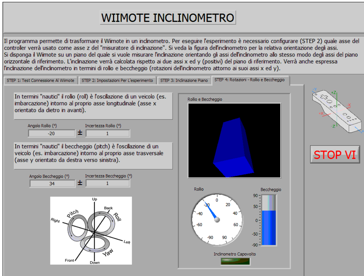
Figura 5.37: Interfaccia grafica STEP 4: Rotazioni - Rollio e Beccheggio
