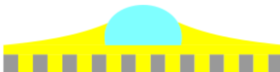
Figura 1.2- Esempio teorico di LIS: goccia (in azzurro) sospesa su olio (in giallo).
