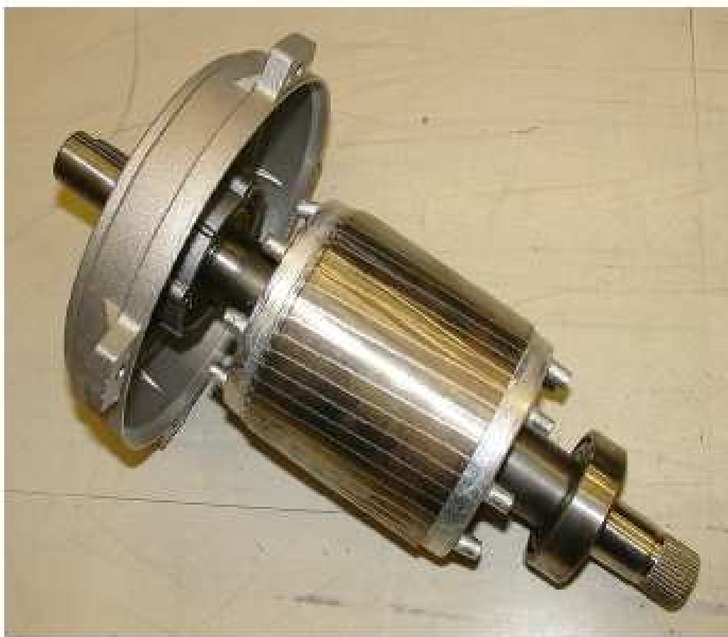
Figura 1.10: Rotore di una macchina asincrona a gabbia di scoiattolo
