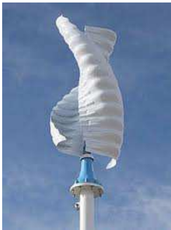
Figura 1.3: Esempio di turbina eolica ad asse verticale
