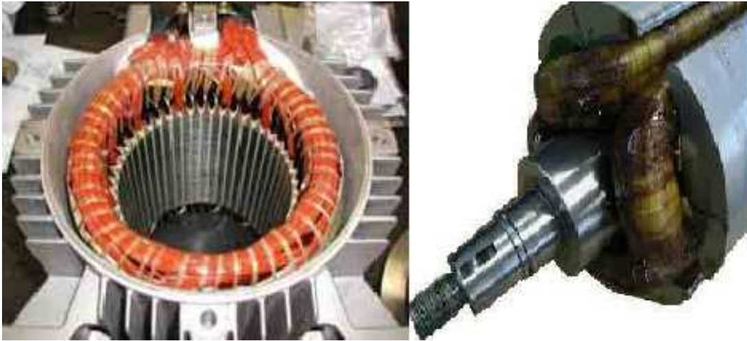
Figura 1.9: Statore e rotore di un generatore sincrono a campo avvolto
