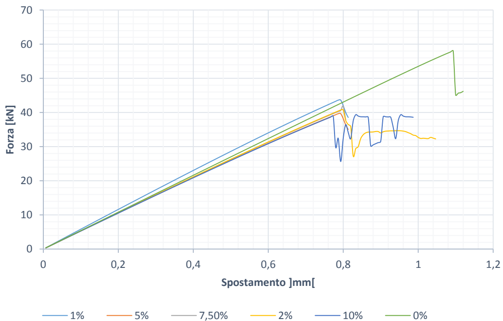
Figura 5.24 Andamento della forza applicata al sistema in fibra di vetro all'aumentare dello spostamento imposto per diversi valori di ampiezza di difetto di circonferenziale. I grafici sono ottenuti dai risultati di analisi non lineari
