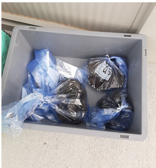
Figura 3.7 - cassetta contenente alcuni campioni rimaneggiati raccolti in situ
