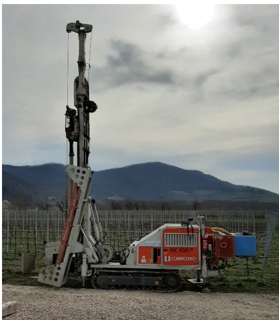
Figura 3.2 - carotiere a rotazione continua
