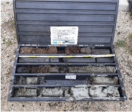
Figura 3.5 - cassetta carotaggio 0-5 m dal p.c.
