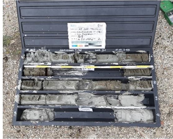
Figura 3.6 - cassetta carotaggio 5-10 m dal p.c.
