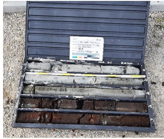
Figura 3.4 - cassetta carotaggio 15-20 m dal p.c.
