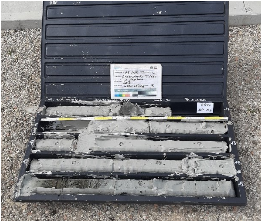
Figura 3.3 - cassetta carotaggio 10-15 m dal p.c.
