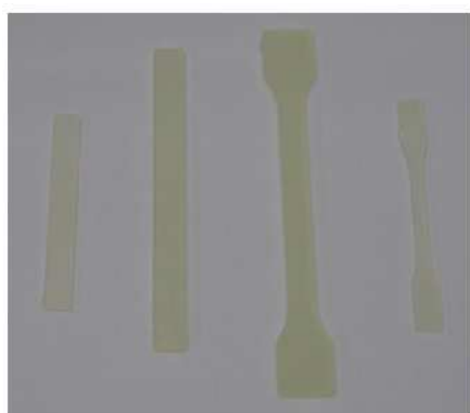
Figure 5.6 e 5.7 Provini stampati di PP (a sinistra) e dei compositi PP/Cosmos Rice (a destra)
