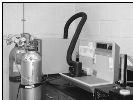
Figura 4.18 Strumento di misura DSC
