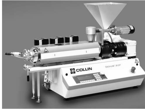
Figura 5.1 Estrusore bivate co-rotante intermeshing Collin
