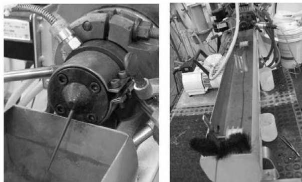
Figura 5.2 Matrice fluida in uscita dalla filiera dell'estrusore e successiva fase di raffreddamento in acqua
