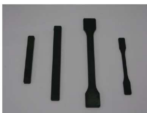
Figure 5.6 e 5.7 Provini stampati di PP (a sinistra) e dei compositi PP/Cosmos Rice (a destra)
