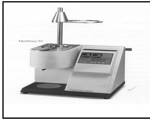
Figura 4.26 Strumento per la misura del Melt Flow Index
