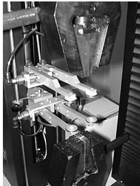
Figura 4.17 Estensimetri del dinamometro Galdabini SUN 2500
