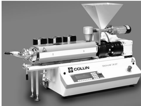
Figura 4.6 Estrusore bivate co-rotante intermeshing Collin
