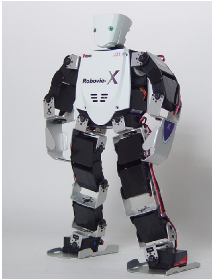
Figura 2.1: Robovie-X, l'umanoide usato in questo lavoro.
