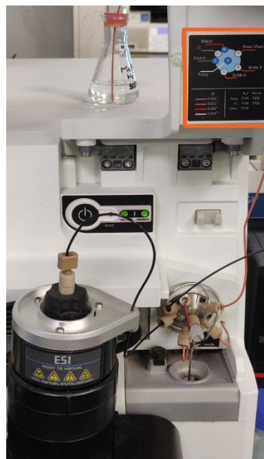
Figura 2.37: testa della sorgente con schema della valvola a sei vie che mostra la possibilità d'analizzare la soluzione derivante dalla colonna o dalle bottiglie A e B
