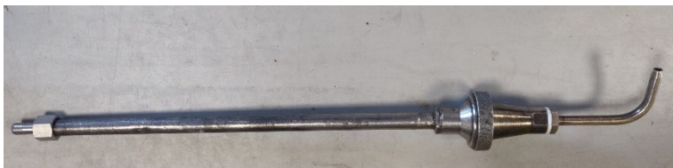
Figura 2.11: sonda in acciaio impiegata per il campionamento delle polveri totali
