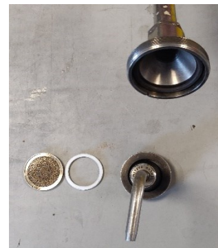
Figura 2.12: supporto della matrice filtrante interno alla sonda
