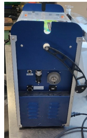
Figura 2.16: lato del campionatore che presenta il supporto ove verrà attaccato il tubo in silicone
