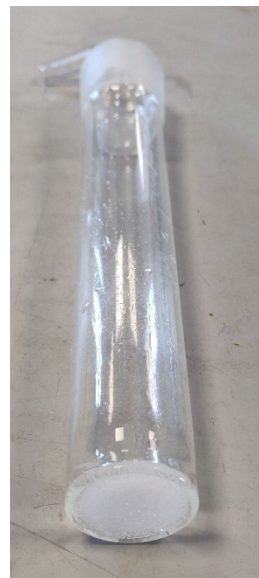
Figura 2.24: dettaglio del setto poroso del gorgogliatore in vetro
