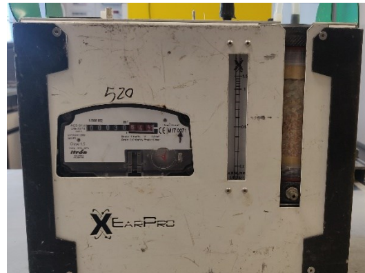
Figura 2.22: campionatore per bassi flussi visto dal lato frontale con in primo piano il flussimetro, il contaltri ed il torrione di gel di silice
