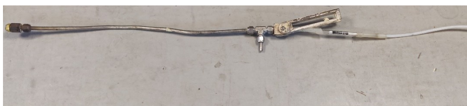
Figura 2.20: sonda in acciaio per campionamenti su fiale a bassi flussi
