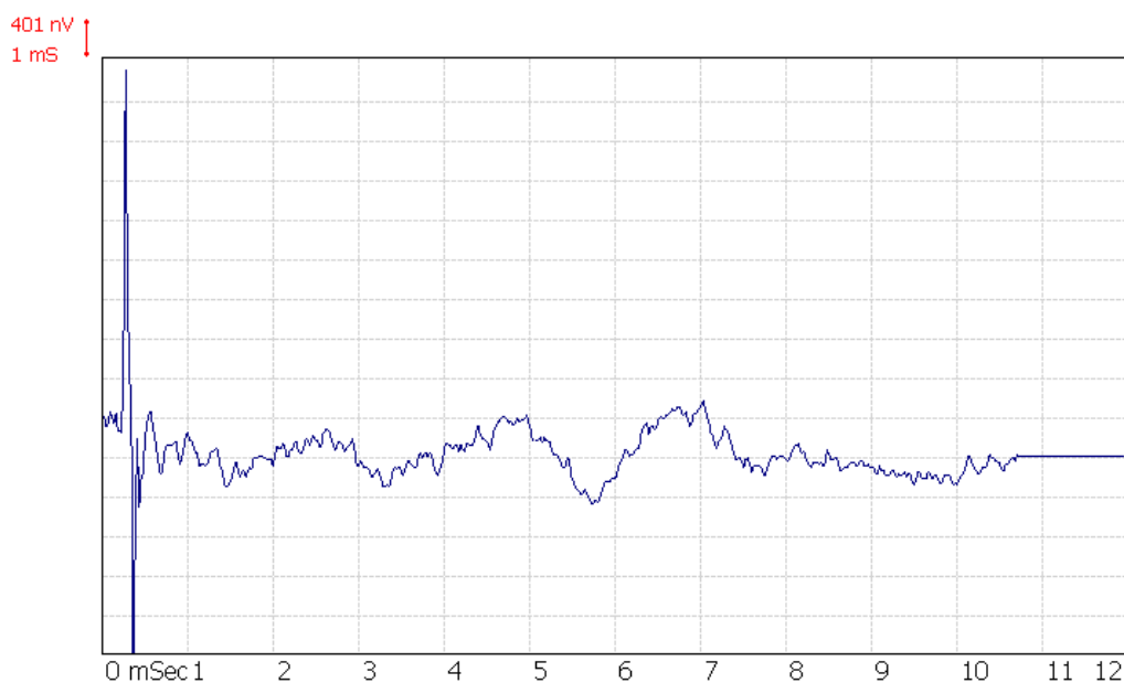
Figura 23 Acquisizione 3: media sincrona di 500 epoche misurate stimolando il paziente con il setup di stimolazione descritto nella Tabella 3.
