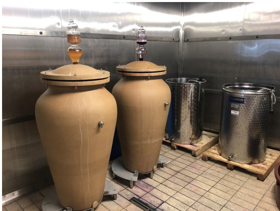
Figura 3 Anfore in terracotta TAVA e Sempre-pieni in acciaio inox usati in questa sperimentazione
