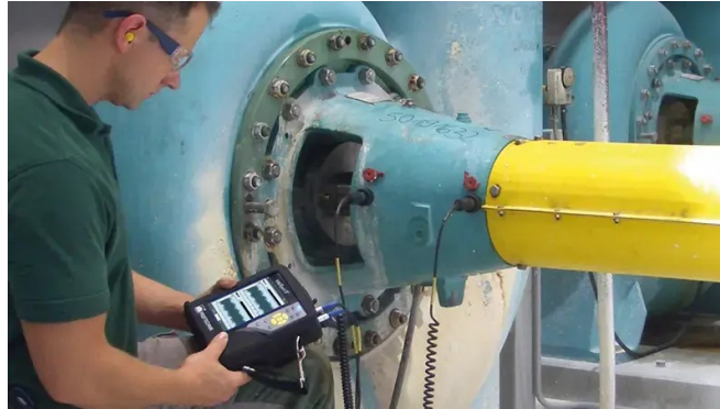
Figura 3. Sistema portatile per il monitoraggio delle vibrazioni ( www.pruftechnik.com )
