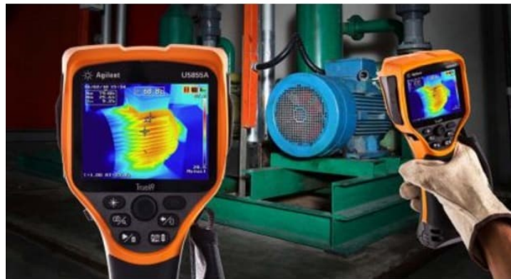
Figura 8. Rilevazione della temperatura di un motore con termocamera ( www.it.rs-online.com )
