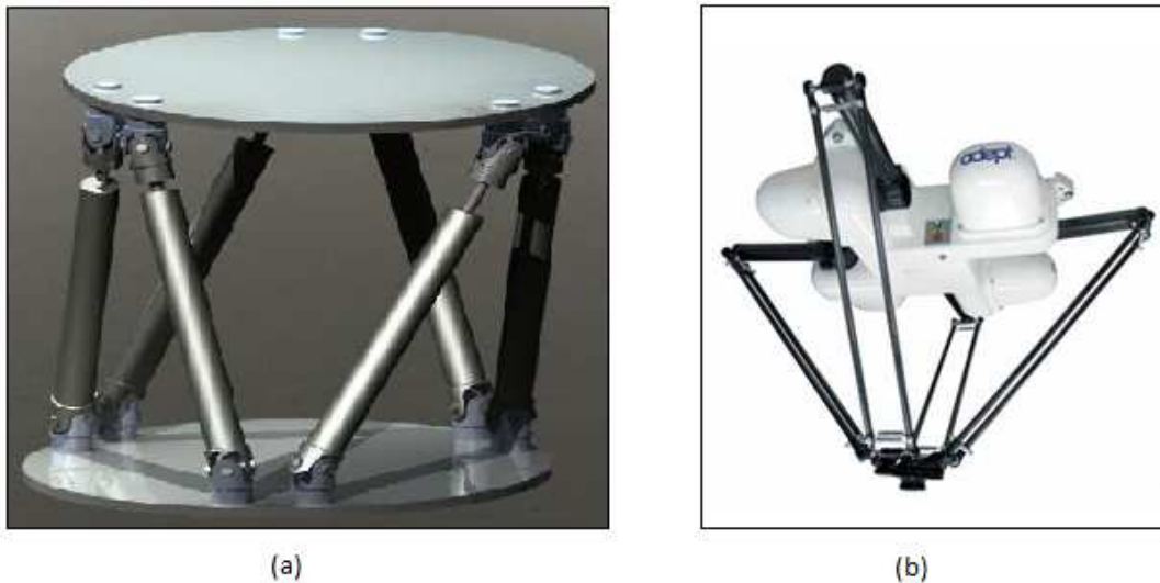
Figura 1.2: esempi di manipolatori paralleli: (a) piattaforma di Stewart, (b) Adept Quattro™.
