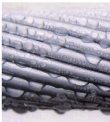
Figura 1.9: Condizione di idrofobicità di un conduttore.
