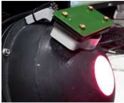
Fig.2.3.4 – Supporto montato sulla sfera integratrice
