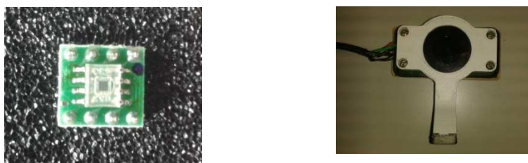
Fig.2.3.4 – Sensore TAOS (a) – Componente di supporto (b)
