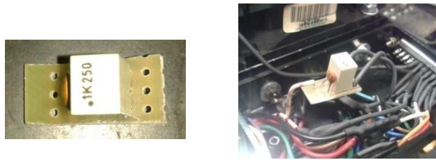
Fig.3.3.6 – Scheda contenente i filtri
