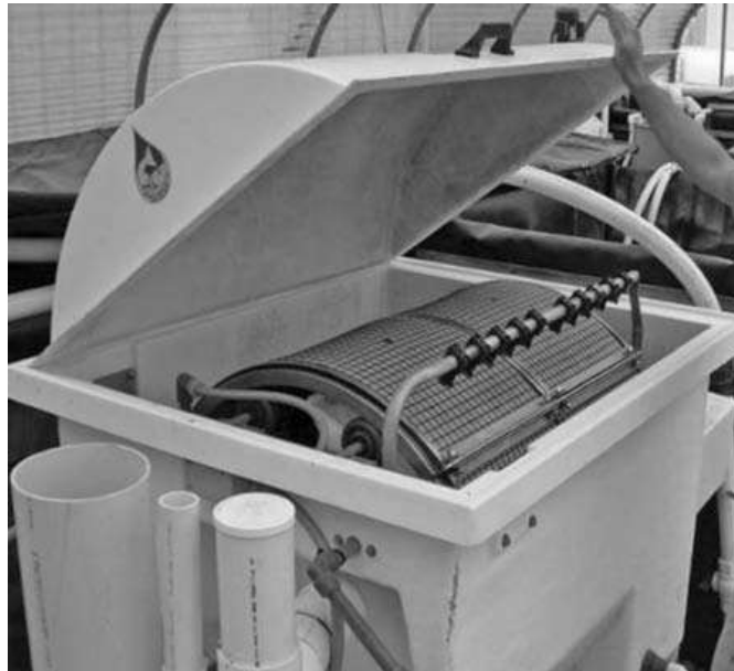
Fig. 10. Filtro microscreen rotante e barre spray per la pulizia
