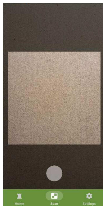
Figura 66 : ROI visiva implementata nell'applicazione. Il rettangolo centrale rappresenta la sottomatrice su cui vengono svolte le operazioni di calcolo.
