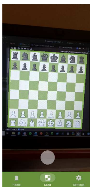
Figura 67 : Riconoscimento dei bordi della scacchiera e feedback visivo all'utente
