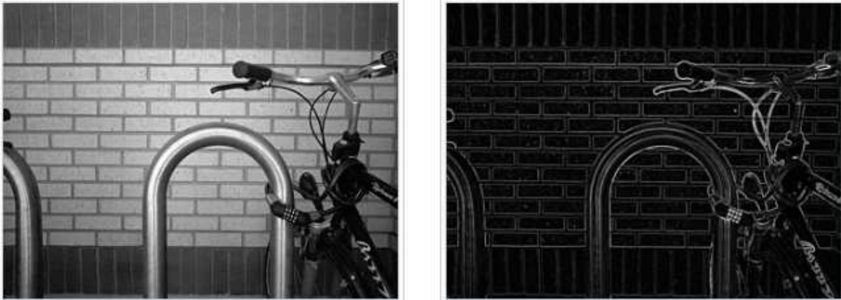
Figure 39.40 : Rilevamento bordi tramite operatore di Prewitt
