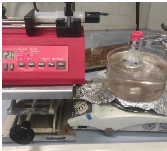
Figura 2.3 Setup sintesi in condizioni starved .
