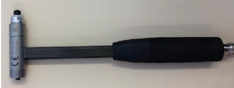
Figura 4.5: Martelletto strumentato PCB
