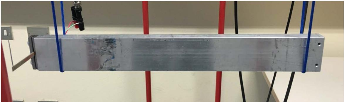
Figura 4.6: barra di alluminio mantenuta in posizione da due corde in modo da essere libera di vibrare. La barra di alluminio con dimensioni 400mm x 50mm x 20mm, ha la funzione di supportare il sistema di misura e di ricevere la martellata che eccita la lamina piezoelettrica.
