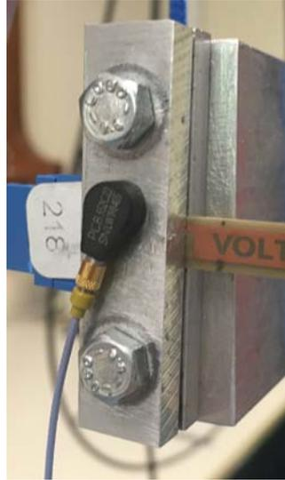
Figura 6.3: sistema di afferraggio dell'harvester
