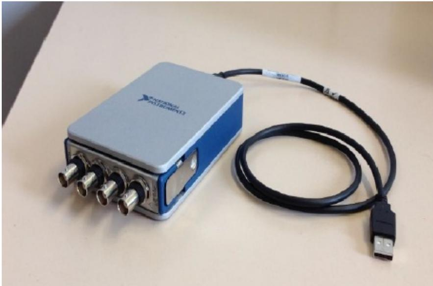
Figura 4.10: sistema di acquisizione NI 9234
