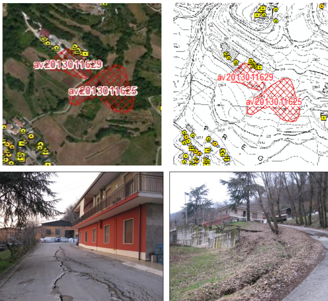
Figura 6.36 Ortofoto, CTR, fotografie della frana av2013011629 che ha interessato la strada davanti l'abitato (Progetto di tesi).
