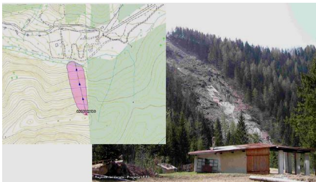
Figura 3.4 Perimetro e relativa foto di una frana occorsa lungo il versante destro del Torrente Missiaga, comune di La Valle Agordina (BL) ( www.regione.veneto.it/difesadelsuolo ).
