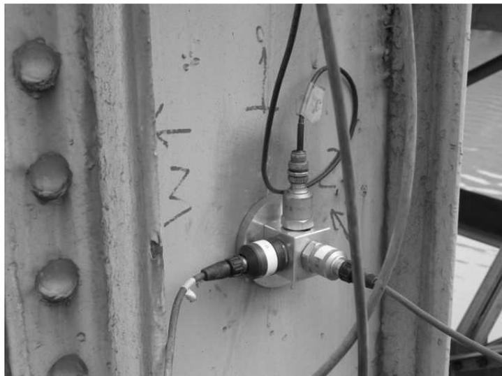
**Figura 9** - Tre accelerometri posizionati secondo le tre direzioni di sviluppo del ponte presso Musile di Piave
