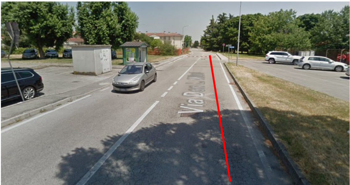
Figura 42: simulazione percorso ciclopedonale in sede promiscua su Via Don Milani. Si propone riduzione del limite di velocità da 50 Km/h a 30 Km/h per tutto il tratto con riduzione dell'aiuola marginale.
