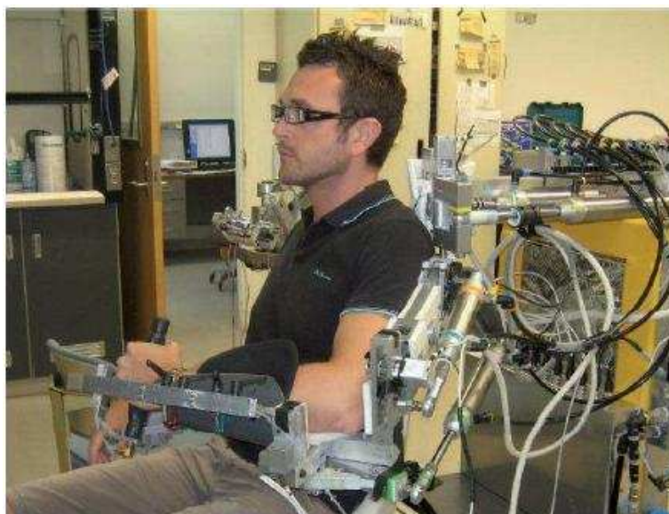
Figura 4.2: Il Pnew-WREX, un dispositivo robotico - esoscheletro - guidato da attuatori pneumatici.
