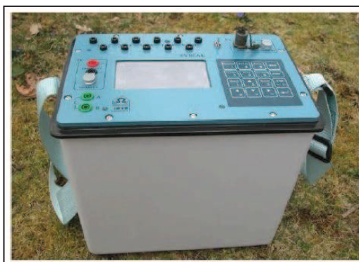
Fig.4.3 - Georesistivimetro impiegato per le misure micro ERT.
