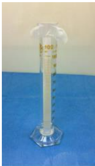
Figura 5 Copertura con pellicola parafilm o con coperchio per garantire saturazione con vapori dell'eluente
