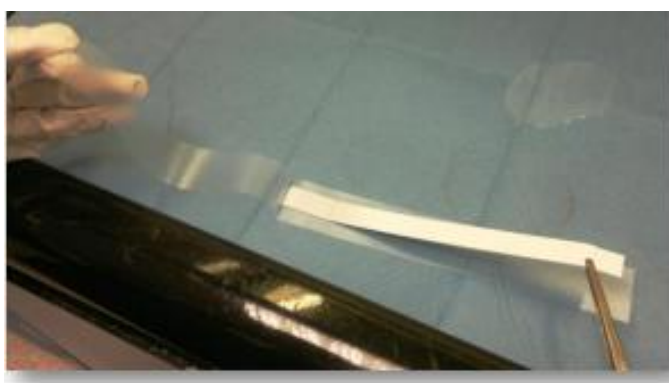
Figura 6 Estrazione striscia cromatografica alla fine della separazione
