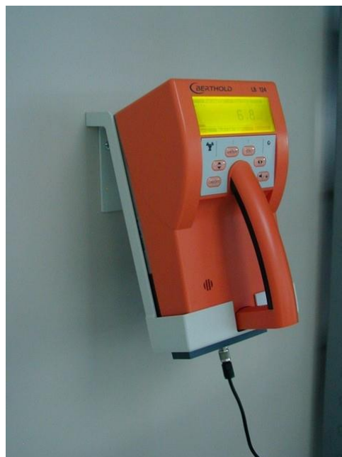
Figura 19 Contatore geiger Berthold su apposito supporto in camera calda medicina nucleare
