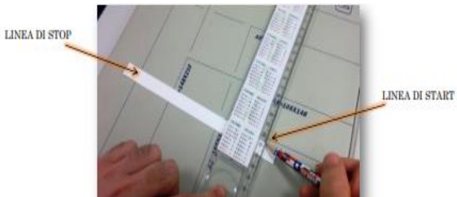
Figura 2 Disegno linea di start e di stop su striscia con matita in grafite
