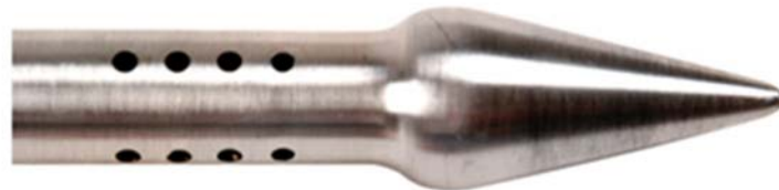
Figura 4.10. Sonda in acciaio inossidabile al cui interno posizionare i film di polietilene per l'installazione in campo tramite tecniche a infissione diretta (direct push). Fonte: Appendice C del Manuale ISPRA "Progettazione del Monitoraggio di vapori nei siti contaminati"
