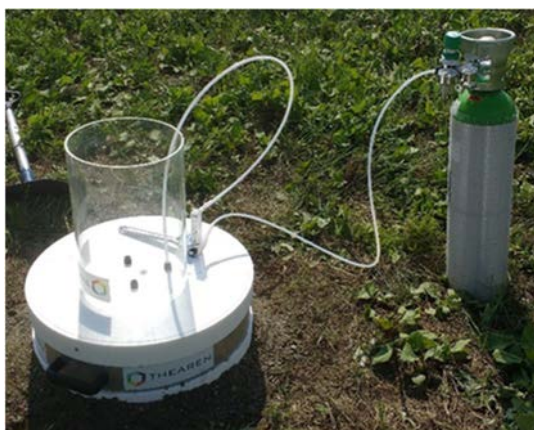
Figura 4.11. Camera di flusso utilizzata per le attività di campo
