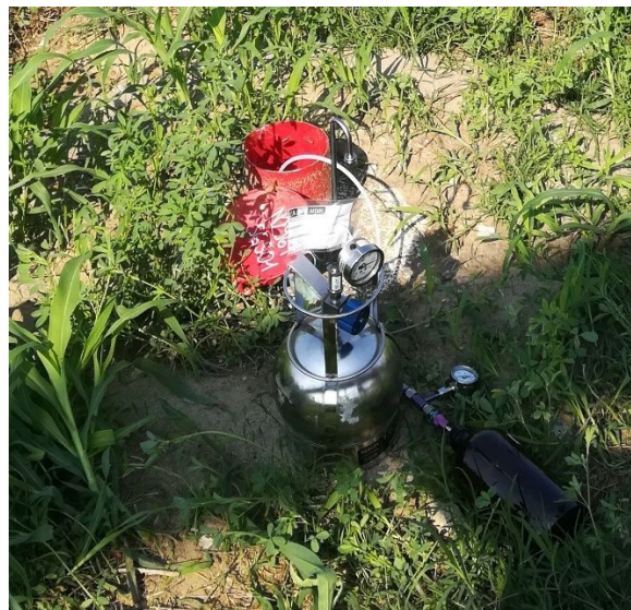
Figura 6.9. Campionamento di aria ambiente con canister in acciaio contemporaneamente al campionamento di soil gas con vacuum bottle
