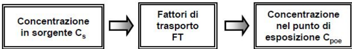
Figura 8.8. Schematizzazione della relazione tra la concentrazione rappresentativa in sorgente ( C_s o CRS ) e C_{poe} . Fonte: Manuale "Criteri metodologici per l'applicazione dell'analisi assoluta di rischio ai siti contaminati", rev.2, APAT.
