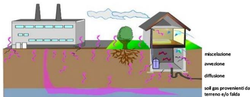
Figura 1.7. Meccanismi di trasporto delle sostanze nel suolo saturo e insaturo (Fonte: Manuale ISPRA "Progettazione del monitoraggio di vapori nei siti contaminati")
