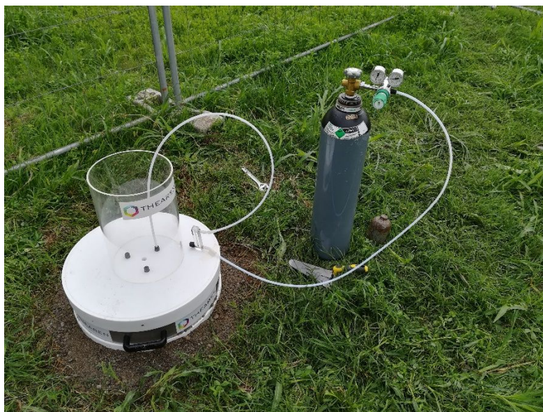
Figura 6.11. Camera di flusso utilizzata nella campagna del 13/09/2018
