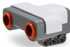
Figura 1.3: Sensore ad ultrasuoni.
