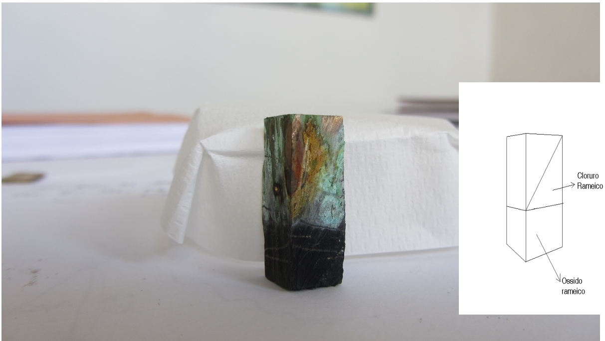
Fig.33 Campione di bronzo dopo la corrosione acida
