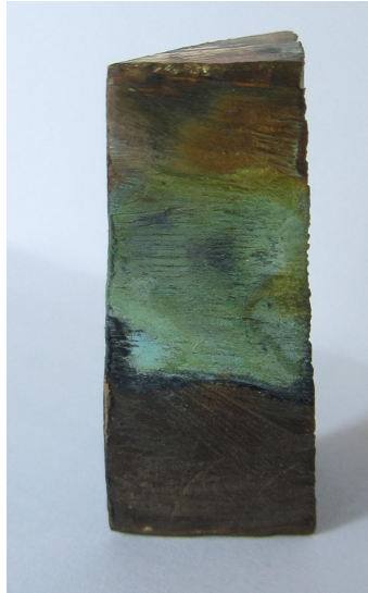
Fig.36 Attacco acido su campione di bronzo rivestito con film SIltea
