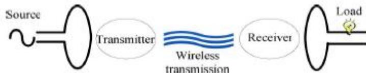
**Figura 1:** Componenti base del sistema wireless.
