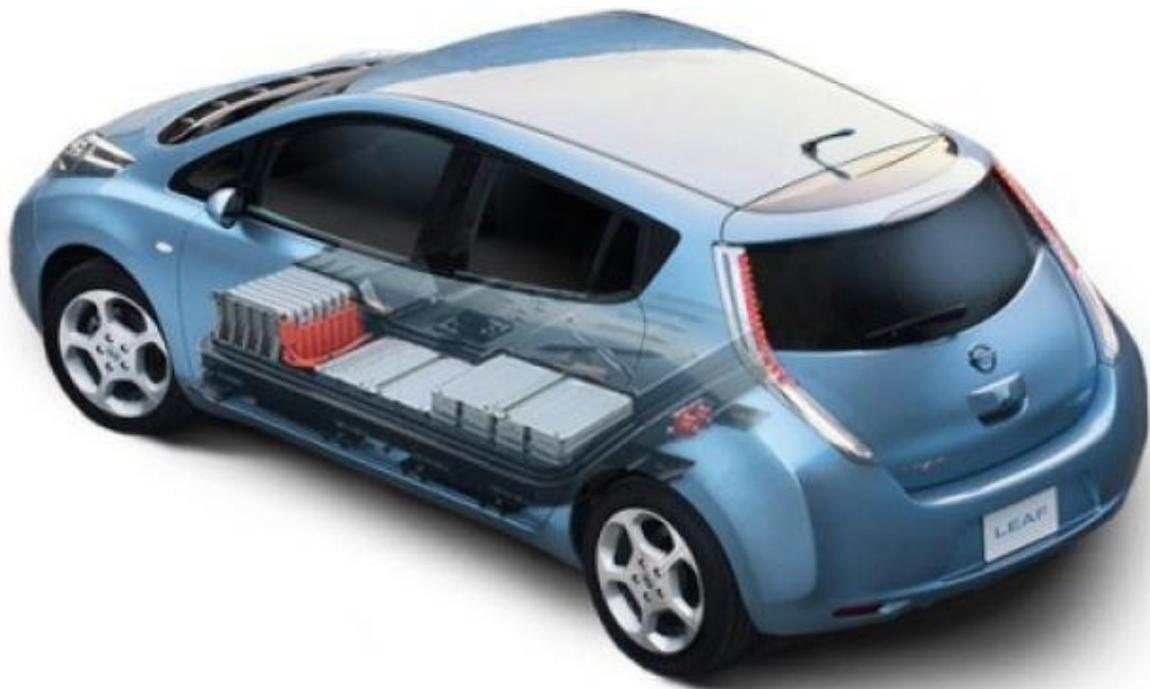
**Figura 26:** Disposizione batteria nella Nissan Leaf.
