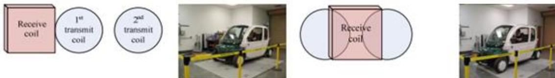
**Figura 21:** Caso iniziale e intermedio della sovrapposizione tra bobina induttrice e ricevente.
