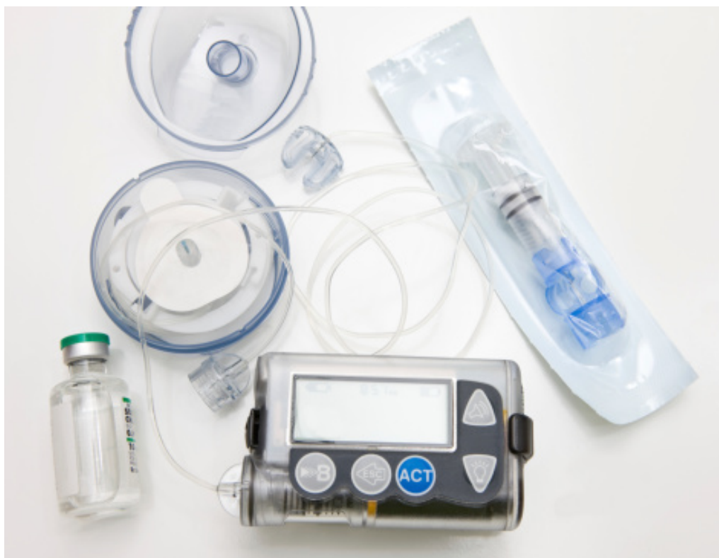
Figura 2.1. Una pompa di insulina collegata al set per l'infusione. È presente anche il dispositivo per l'applicazione dell'ago minimamente invasivo per la somministrazione sottocutanea.
