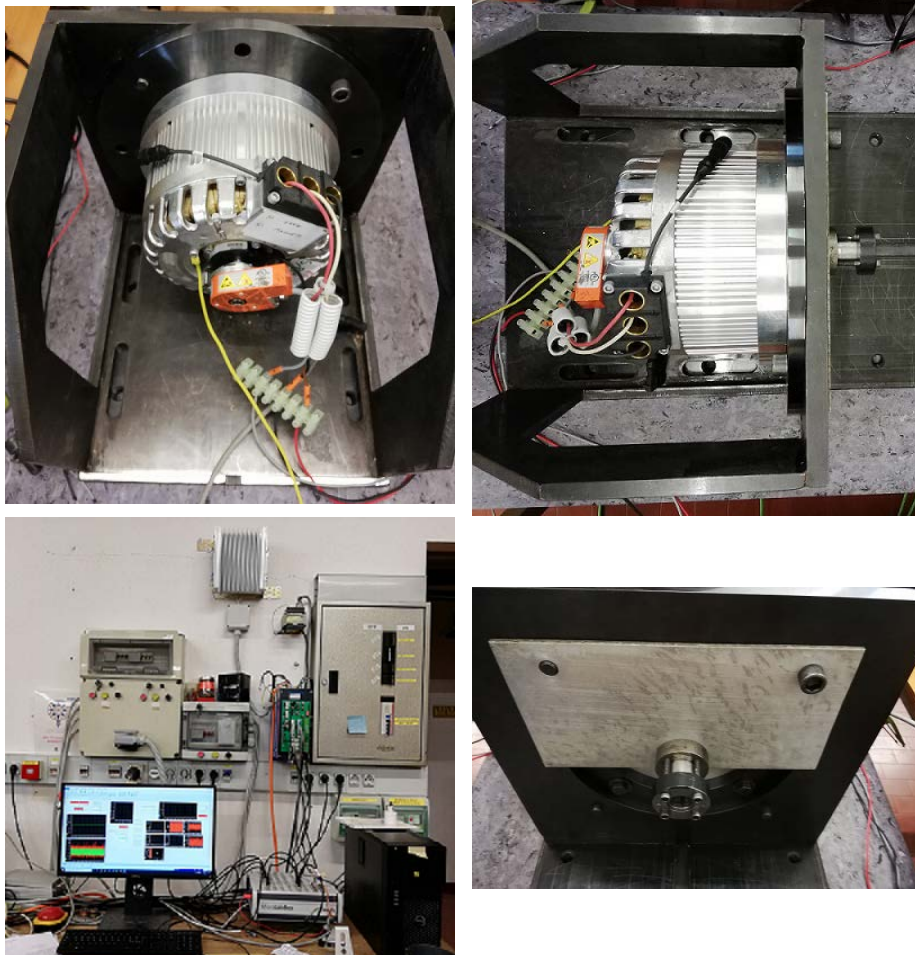
Figura 7.2: Foto del banco prova, del motore e del blocco per tenere ferma la macchina, utilizzati nelle prove sperimentali.
