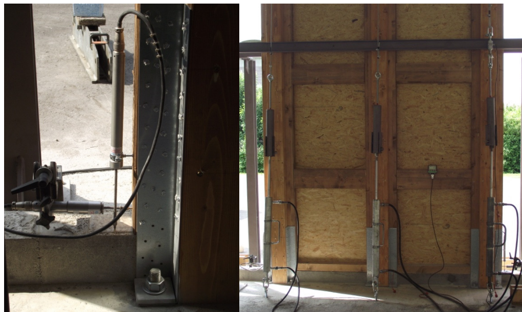
Figura 4.11 - Particolare dell'holdown e vista generale
