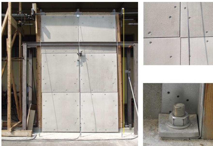
Figura 2.8 - Condizioni di rottura della parete - vista complessiva (a sinistra), dettaglio scorrimento delle lastre (in alto a destra), dettaglio deformazione piastra di base tipo holdown (in basso a destra).
