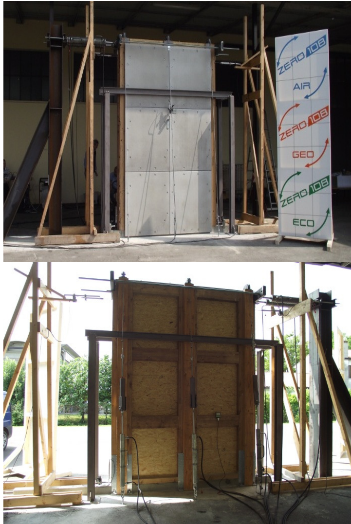
Figura 2.2 - Allestimento della prova: lato esterno (in alto), lato interno (in basso).
