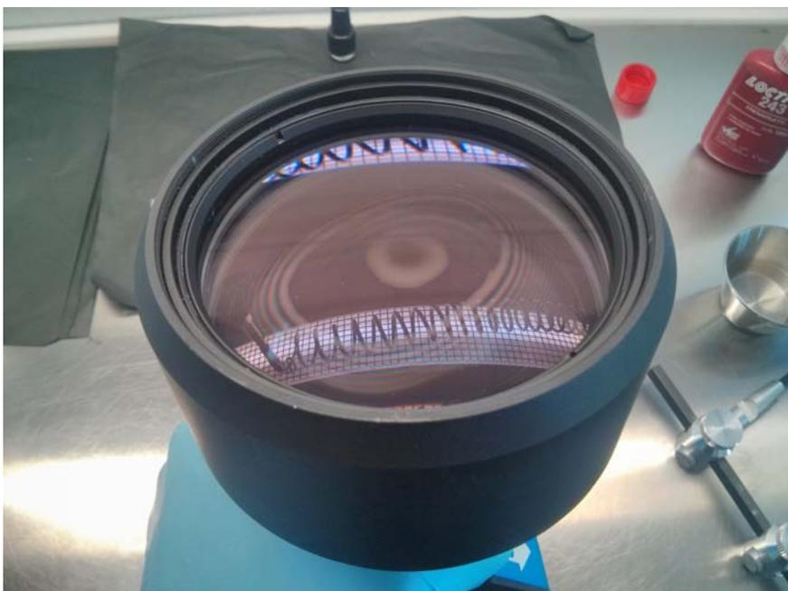
Figura 4.12: Frange di Newton viste direttamente dalla lente
