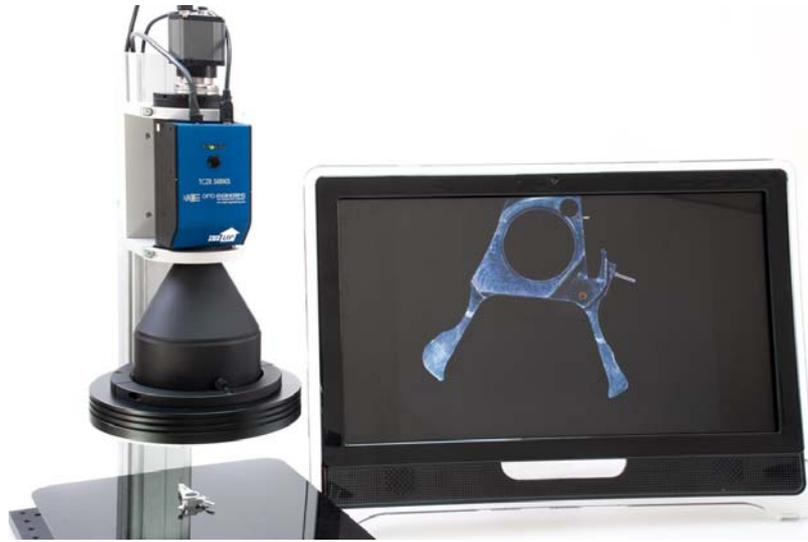
Figura 3.7: Esempio di obiettivo telecentrico usato per misurare componenti meccanici
