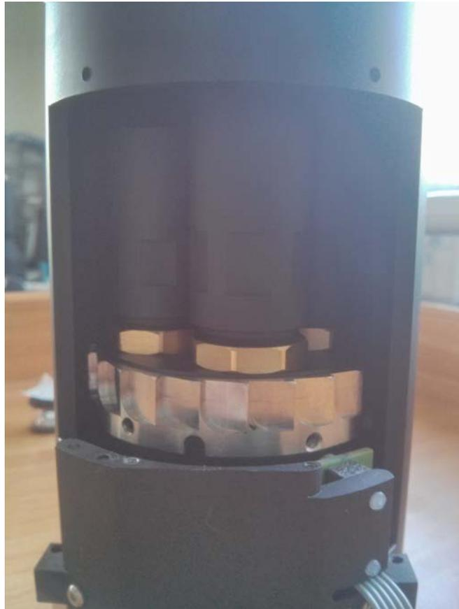
Figura 4.1: I 4 oculari sulla ruota che possono essere selezionati
