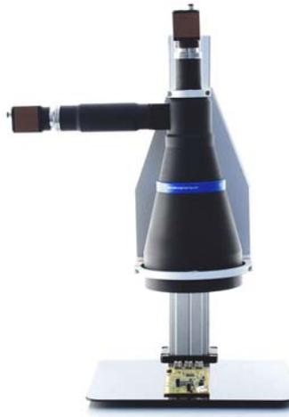
Figura 3.6: Circuito elettronico misurato tramite un obiettivo telecentrico per rilevare imperfezioni
