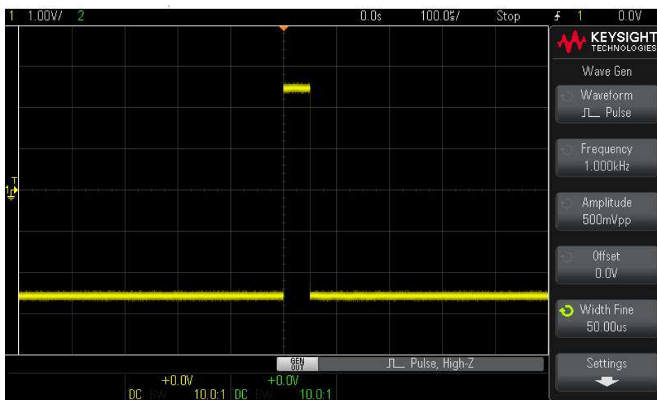
Figura 30 – Impulso singolo nel tempo sull'oscilloscopio [7]
