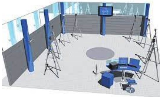
Figura 3.1: Schema della strumentazione stereofotogrammetrico. [57]
