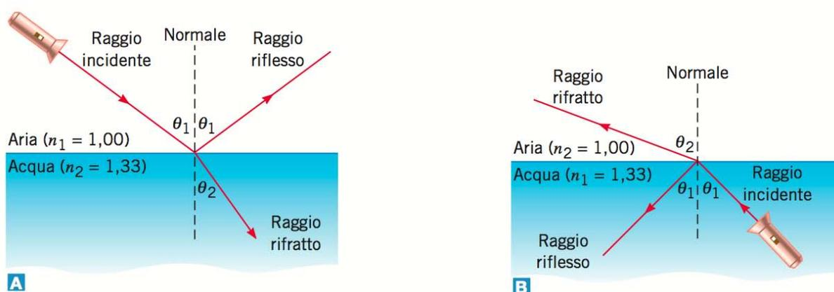
Figura 1.1: Riflessione e rifrazione della luce fra due mezzi diversi  $m_1$  e  $m_2$  [15]
