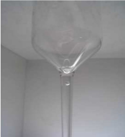
Fig. 1: esempio di vuoto d'aria inglobato nel componente stampato
