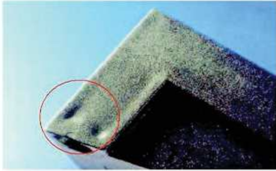
Rechupes (hundimientos, sink marks).
