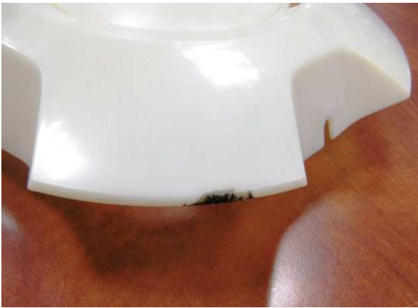
Fig. 4: esempio di bruciatura in un componente stampato
