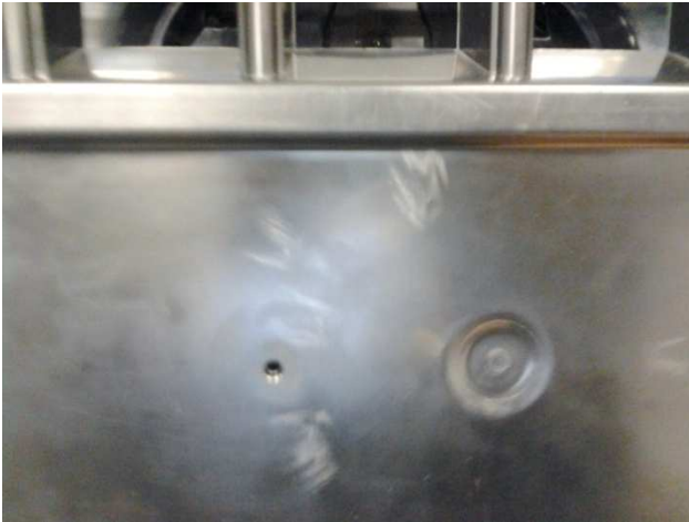
Fig. 10: esempio di flow lines in un componente stampato
