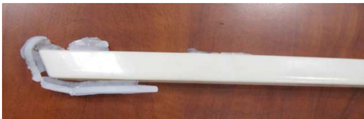
Fig. 9: esempio di bava in un componente stampato
