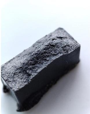
Fig. 6 – Superficie di frattura a cono, corrispondente ad una bassa portata d'iniezione
