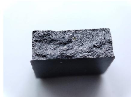
Fig. 7 – Superficie di frattura piatta, corrispondente ad un'alta portata d'iniezione
