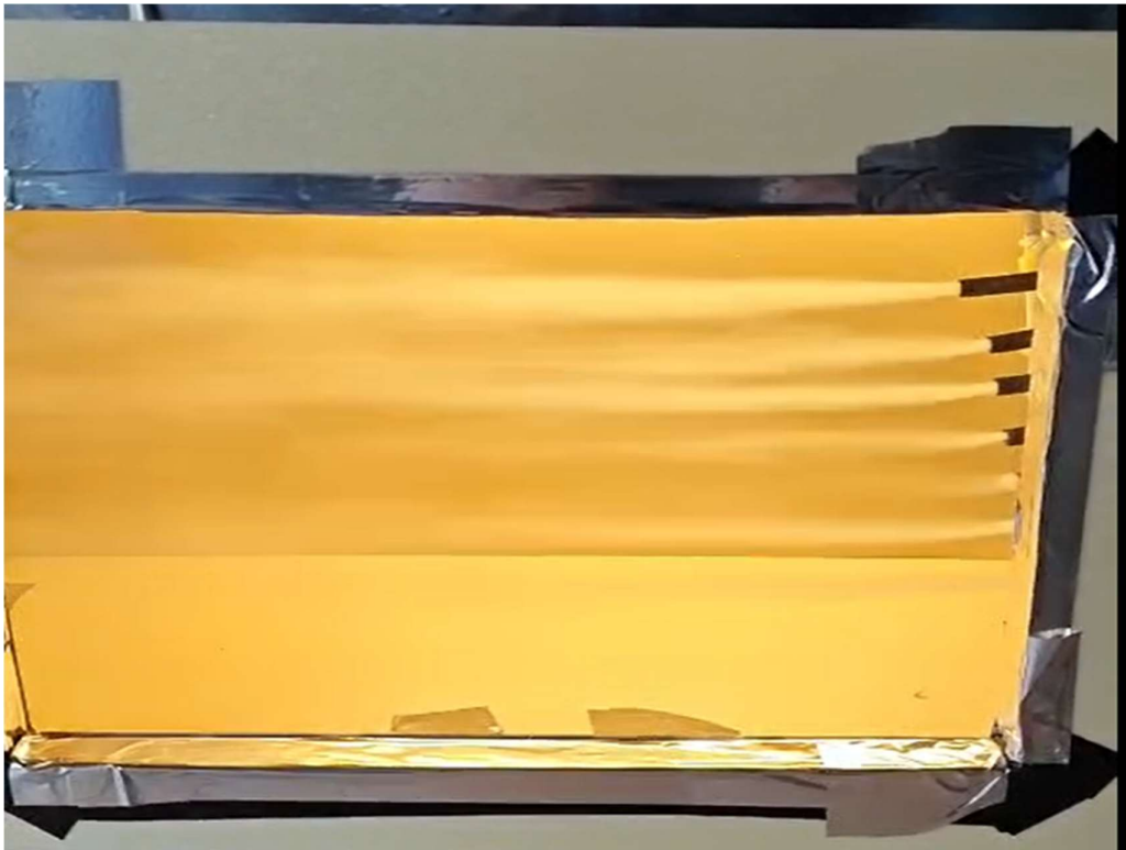
Figura 52: Flusso indisturbato in galleria
