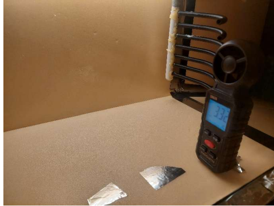
Figura 50: Misura velocità in galleria tramite anemometro a paletta
