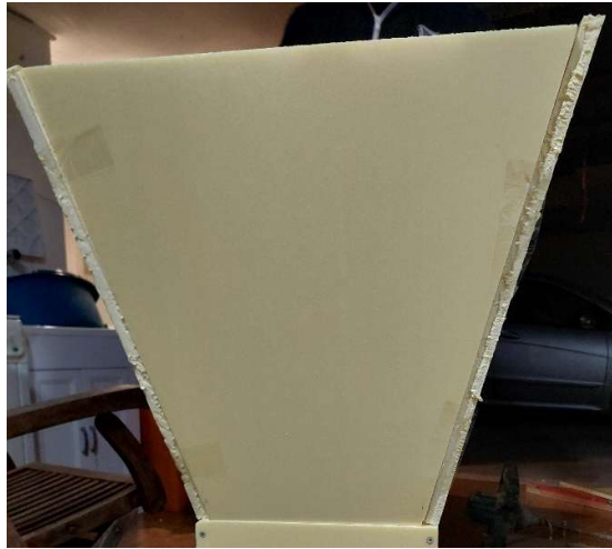
Figura 43: Condotto convergente costruito
