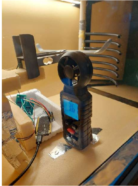
Figura 86: Velocità rilevata sul ventre dell'ala principale
