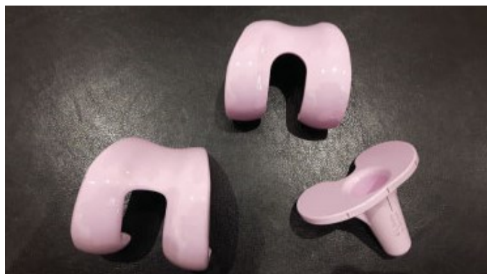
Figura 3.7: componenti femorali e tibiali realizzati in allumina
