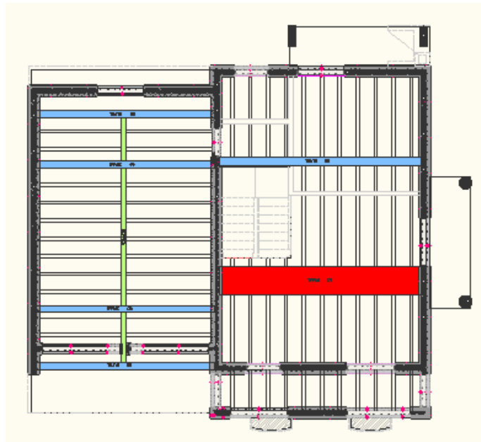
Fig. 33: Pianta Strutturale Solaio. Si considera il volume rettangolare a sinistra della pianta. Evidenziate in azzurro le travi che sorreggono le pareti in falso sovrastanti; in verde la correa suddivisa in tre tratti.
