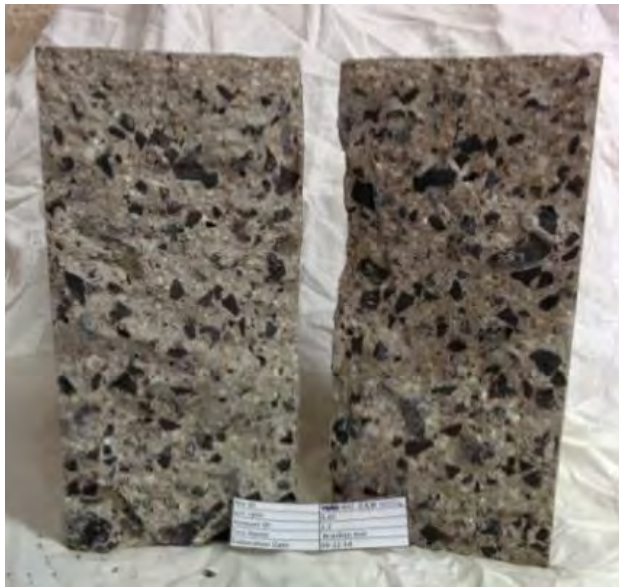
Figura 4.176 Calcestruzzo con EAF dopo prova brasiliana.
