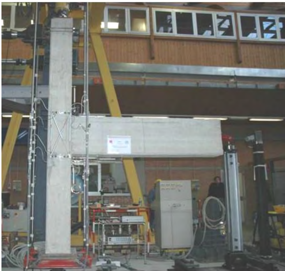
Figura 3.11 Visuale del nodo pronto per essere testato, si possono notare il castello necessario per l'applicazione dello sforzo assiale e tutte le strumentazioni necessarie al rilevamento degli spostamenti e delle deformazioni.
