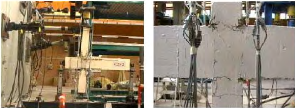
Figura 3.18 Nodo interno C23-2, dove è possibile osservare il setup di prova (sinistra) e la rottura del nodo al termine della prova (destra).
