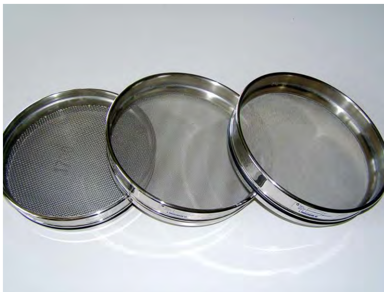
Figura 4.2 Vagli utilizzati durante l'analisi granulometrica.
