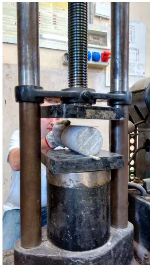
Figura 4.14 Posizionamento di un provino cilindrico nella pressa utilizzata per le prove.
