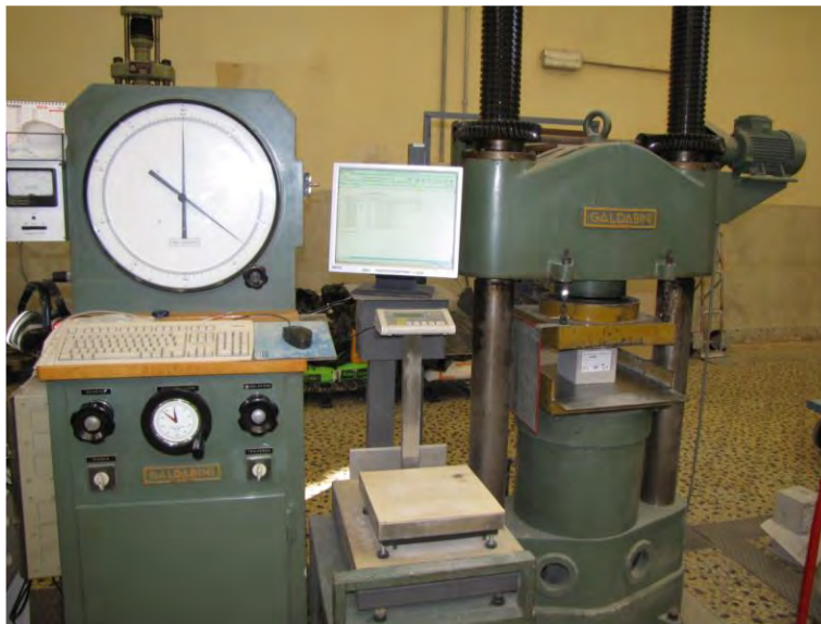
Figura 4.6 Pressa utilizzata per le prove di compressione.
