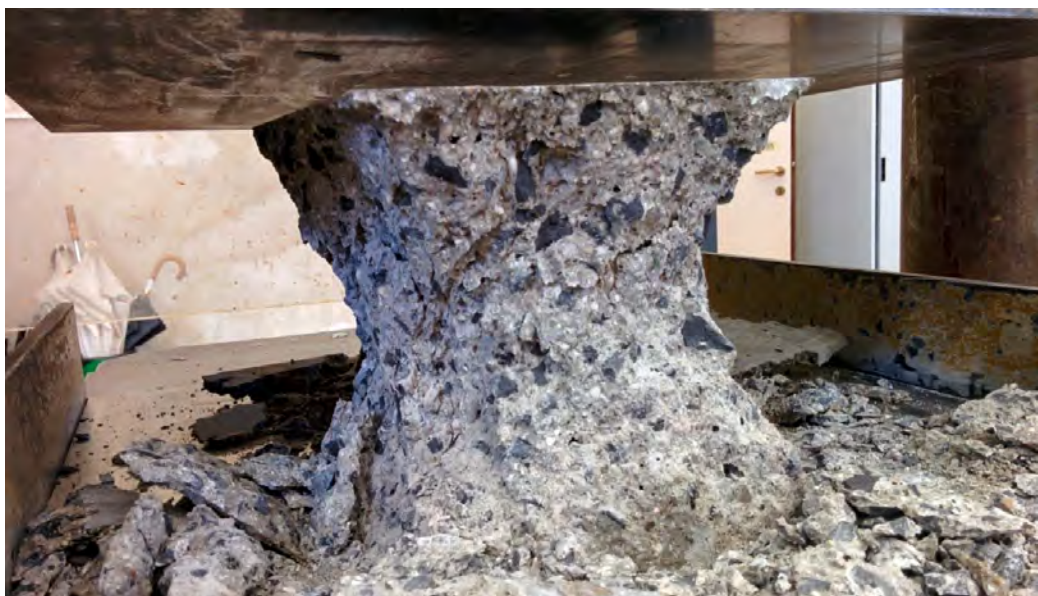
Figura 4.8 Provino di calcestruzzo contenente EAF dopo la prova di compressione.
