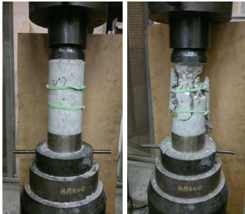
Figura 4.12 Provino sottoposto a prova di compressione, prima e dopo.
