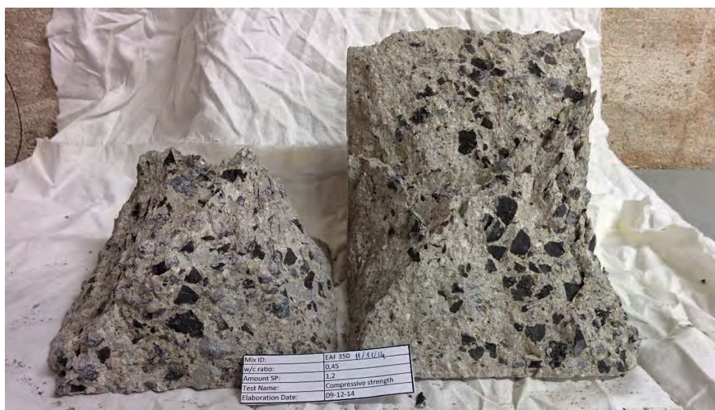
Figura 4.9 Provino di calcestruzzo contenente EAF dopo la prova di compressione.
