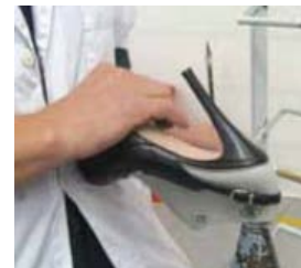
Figura 1.48 - Rimozione della forma (www.impresasicura.org)
