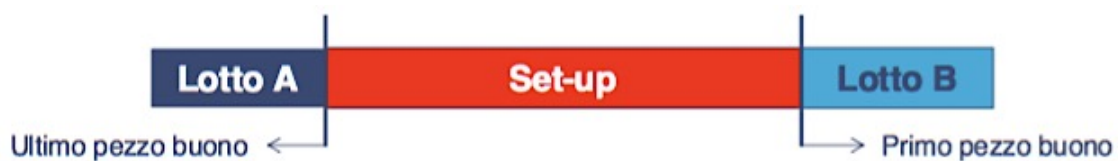
Figura 2.9 – Schematizzazione del tempo di set-up. (Fonte: www.confindustria.it)
