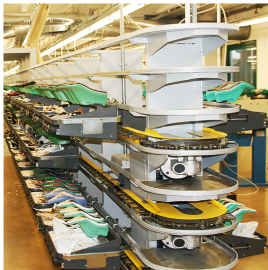
Figura 1.36 - Manovia del montaggio. (Fonte: www.fondmetalli.it)
