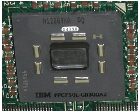
Figura 40: Esempio di processore con package inverso, per il quale la parte posteriore del die è stata meccanicamente assottigliata, eliminando circa il 25% del suo spessore originale
