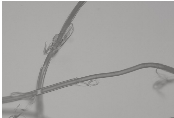
Figura 8-5: Vista longitudinale di una fibra bicomponente PES - coPES in seguito a fusione parziale del mantello
