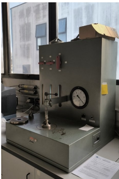
Figura 6-6: Tester di permeabilità
