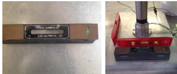
Figura 6.5: Strumenti utilizzati per la regolazione del piano di appoggio.
