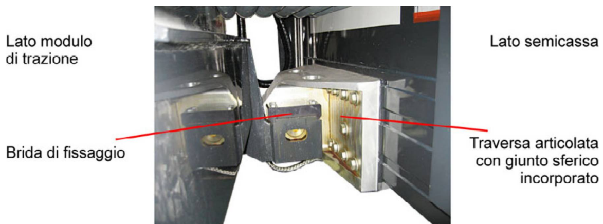
Figura 4.2.7.2 - Articolazione sferica di collegamento tra semicassa e modulo motore
