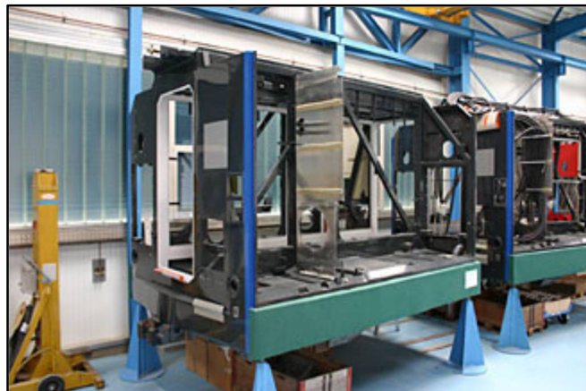
Schema 4.2.5 – c) Struttura del modulo di trazione in acciaio
