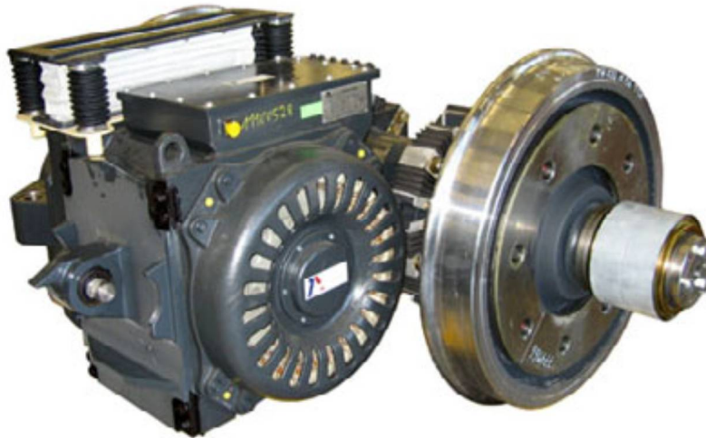
Figura 4.2.16.1 – Motore elettrico asincrono e relativa asse motrice
