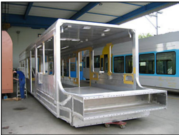
Schema 4.2.5 – a) Struttura grezza modulo semicassa
